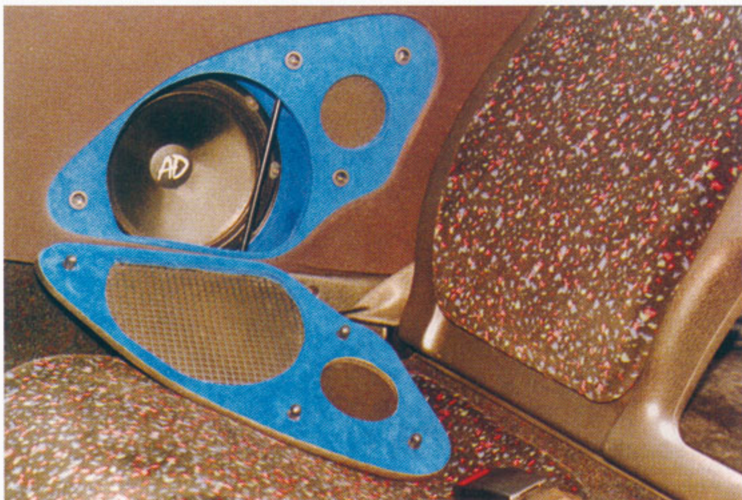
Eccellente il lavoro di ricostruzione delle fiancate posteriori che ospitano i subwoofer, realizzati con una seconda coppia di AD 200 SPL.
