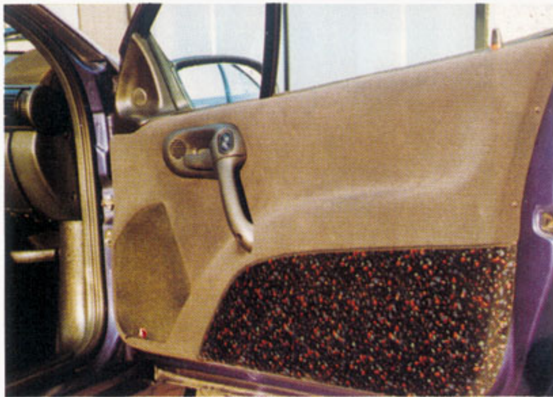
La portiera egregiamente modificata ospita un altoparlante più grande di quello di serie, in questo caso un woofer AD 200 SPL.
