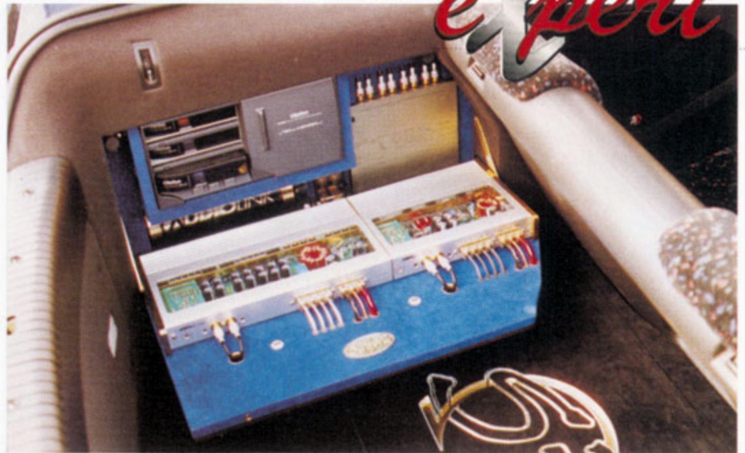
Il lato destro del bagagliaio ospita il CD changer, il DSP, un condensatore e due amplificatori finali Sinfoni modelli Amplitude 45.2 e 90.2.
