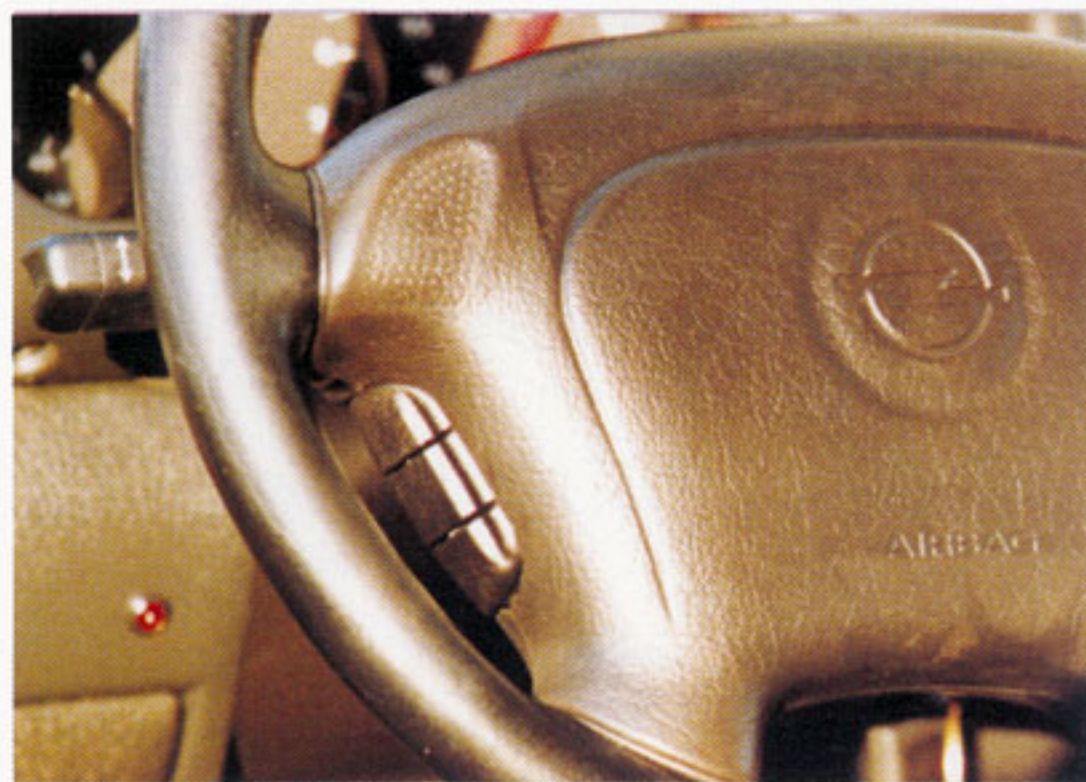
La pulsantiera installata sul volante e collegata ad un telecomando Clarion opportunamente "sezionato" realizza ciò che si definisce telecomando a volante.
