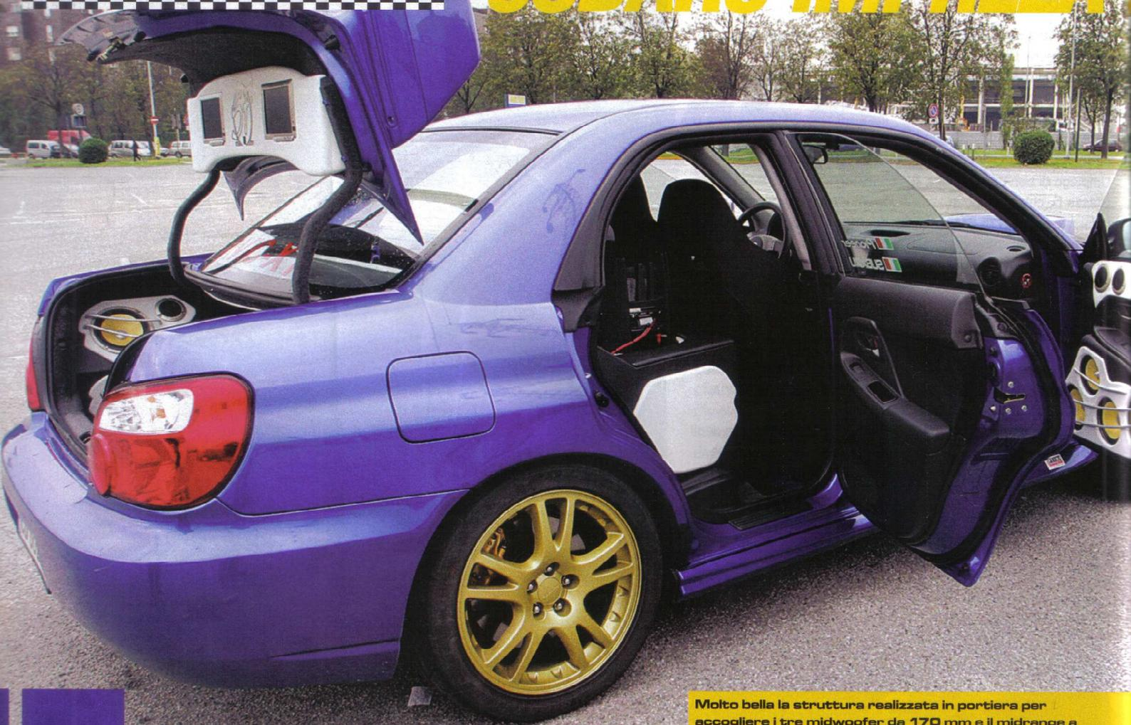
Molto bella la struttura realizzata in portiera per accogliere i tre midwoofer da 170 mm e il midrange a cono da 130. Non è da meno il box dei subwoofer e per fargli posto si è dovuto eliminare il sedile posteriore...
