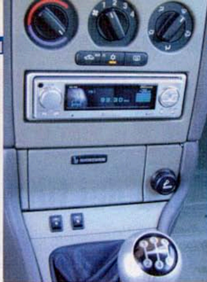
Nella predisposizione nella parte bassa del cruscotto, opportunamente ricavata, è stata invece inserita la prestigiosa sorgente dell'impianto audio.
