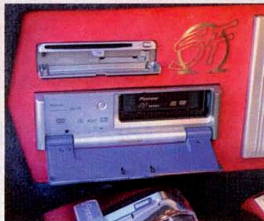
Un particolare della zona in cui sono installati il cambiaDVD e l'unità di navigazione, al fine di mostrare la cura posta dall'installatore ai particolari.
