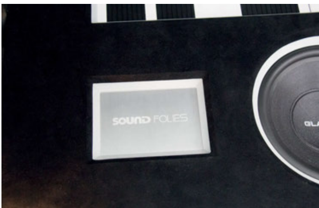
La "finta" elettronica che fa il "paio" con il processore per rendere simmetrico il disegno del bagagliaio, realizzato a partire da un telaio di un processore originale Mosconi, in realtà nasconde i fusibili delle elettroniche.
